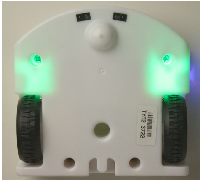
FIGURE 3.1 – Le dessous de Thymio avec ses détecteurs de sols
